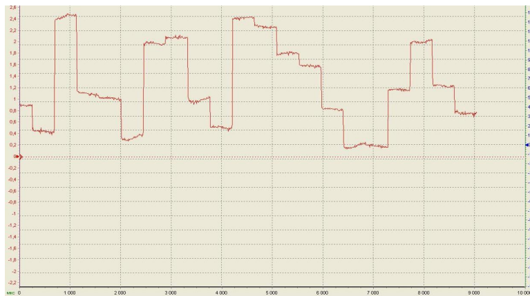
Рис. 26 – Вид форми струму в режимі «ОПФТ»
