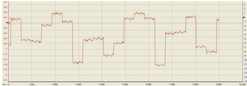
Рис. 25 – Вид форми струму в режимі «ДНФТ»
